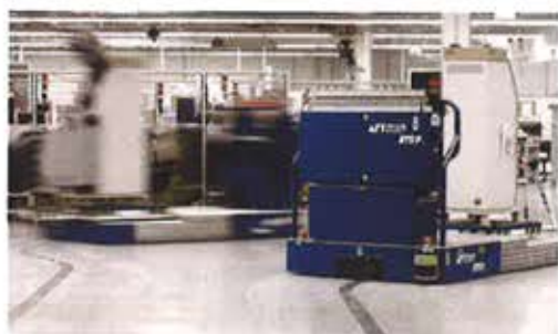
Bild 1. Das induktive Energiesystem CPS zur Versorgung fahrerloser Transportfahrzeuge vermeidet Kabel- und Schleifkontakte sowie Bodenebenheiten. (Bild: Vahle-Gruppe)
