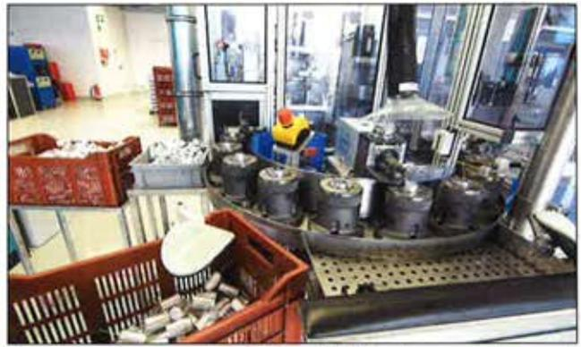
**Kondensatoren werden mit Kontaktfähnchen versehen und verschlossen**
