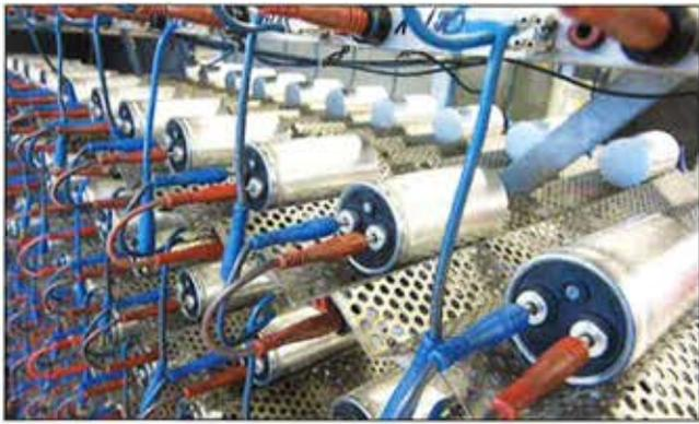
**Nachformierung von Elektrolytkondensatoren**
