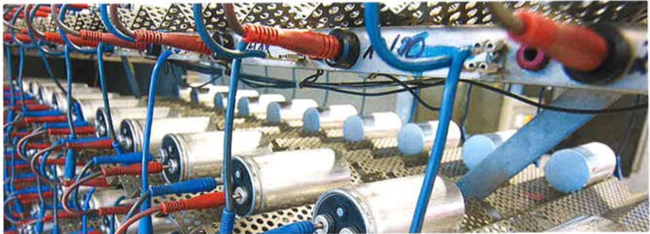
Im Teststand werden die fertigen Film-Kondensatoren auf ihre Funktion getestet und unter Spannung gesetzt.
