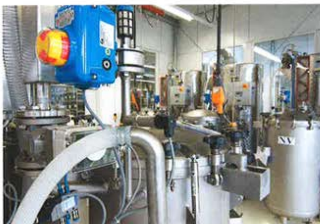
Die leitende Elektrolyt-Flüssigkeit für Aluminium-Elektrolyt-Kondensatoren wird in Tanks aufbewahrt.
