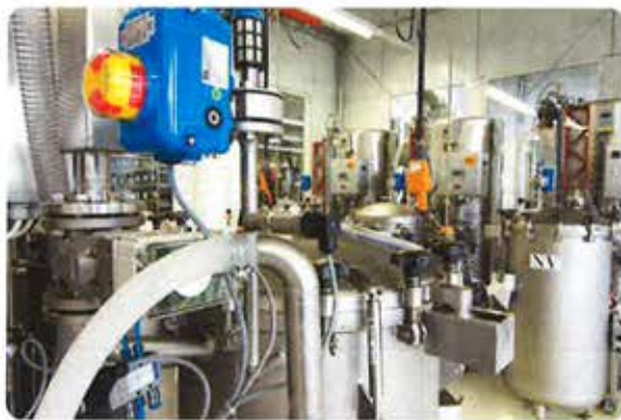
Bild 4: Die leitende Flüssigkeit für Aluminiumelektrolyt-Kondensatoren wird in Tanks aufbewahrt.
